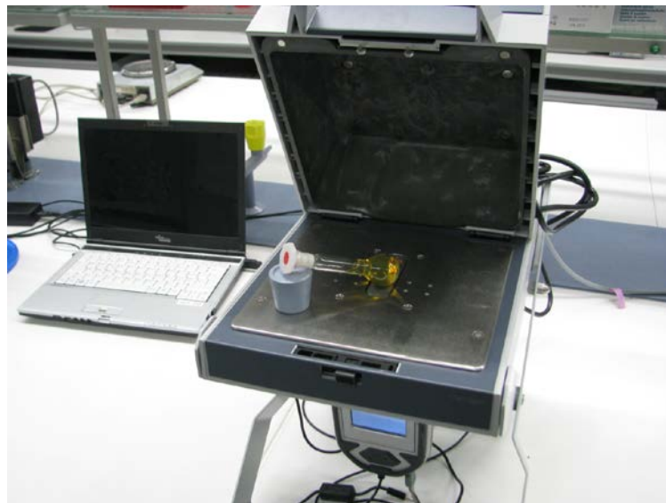
Abbildung 16: Messung der Silber-Suspensionen und Gewebe im abgeschirmten Teststand.
