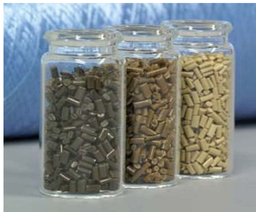
Abbildung 3: Silberhaltiges Polymergranulat von HeiQ Materials AG, welches metallisches Silber-Mikrokomposit enthält, und als Masterbatch bereitgestellt wird.
