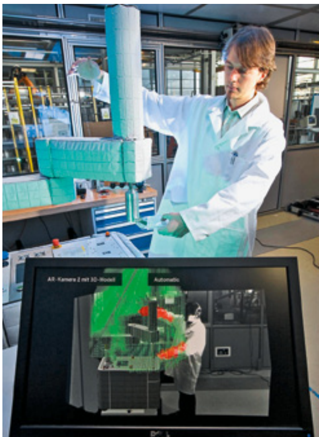
Abb. 2 Eine Anwendung von AmI: Der Roboterarm kann dem Menschen zur Hand gehen, ohne ihn zu verletzen. Dafür ist eine ausgefeilte Sensorsteuerung notwendig.
