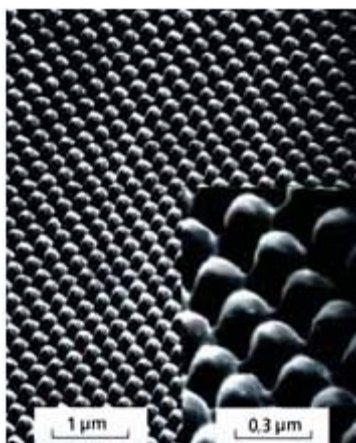
Abb. 3 > Elektronenmikroskopische Aufnahme der nanostrukturierten Oberfläche einer Glasbeschichtung.
